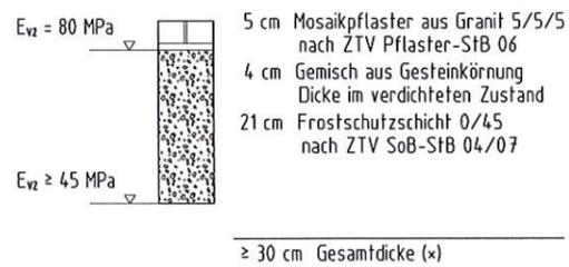
Deckenaufbau Fahrbahn gemäß RStD 12,
