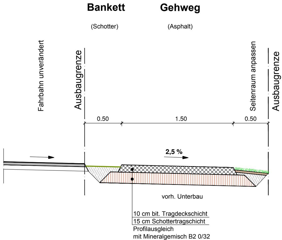
Eine entsprechende Tragfähigkeit und Frostsicherheit ist infolge eines fehlenden Baugrundgutachtens und damit einer Bemessung des Oberbaus nicht nachweisbar.
