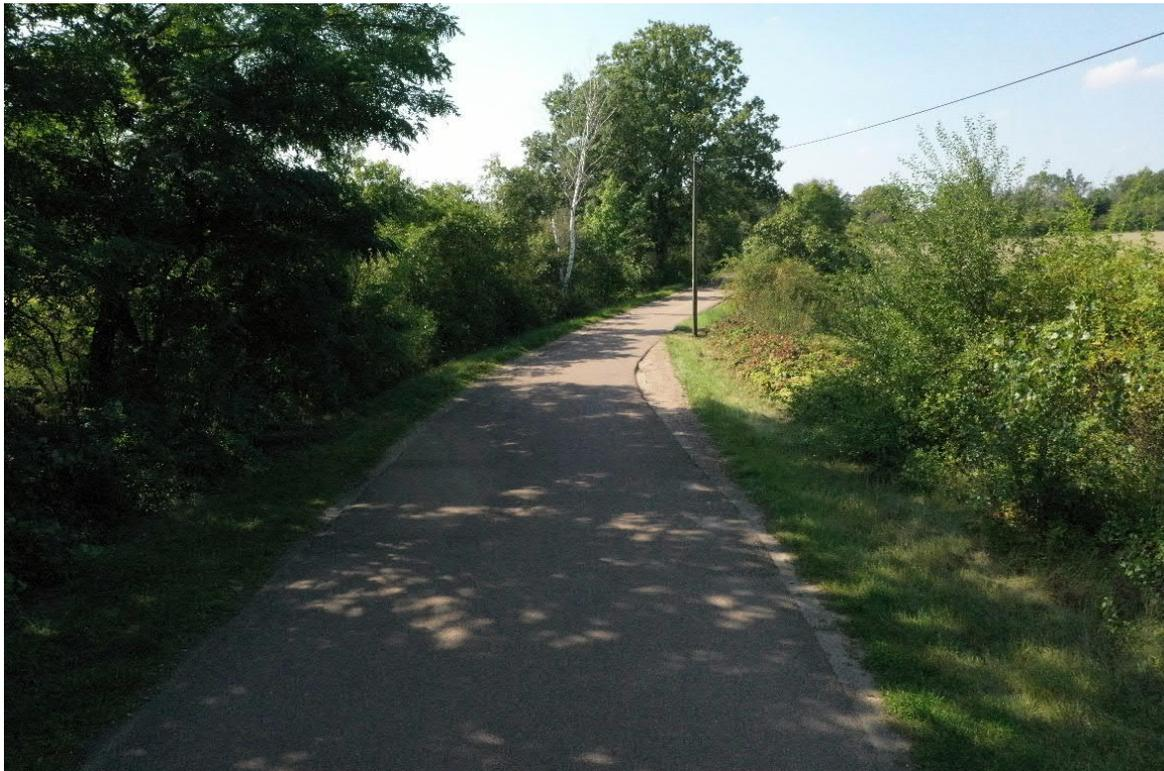
Schmale Fahrbahn im Mittelweg, keine Kurvenverbreiterung, keine Ausweichmöglichkeit bei Gegenverkehr, angehäufte begrünte Seitenbereiche statt Bankett
